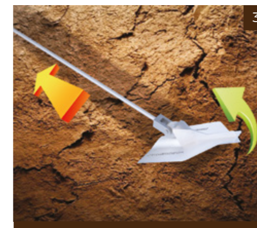
Naciągnięcie żerdzi nośnej i nadanie jej tym samym wstępnego naprężenia. Nośność uzyskuje się dzięki obróceniu się elementu nośnego o 90°
