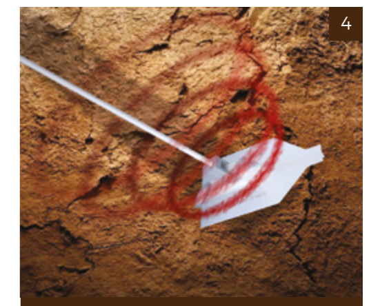
Powstanie strefy naprężenia w kształcie ściętego stożka i uzyskanie w ten sposób nośności całego systemu
